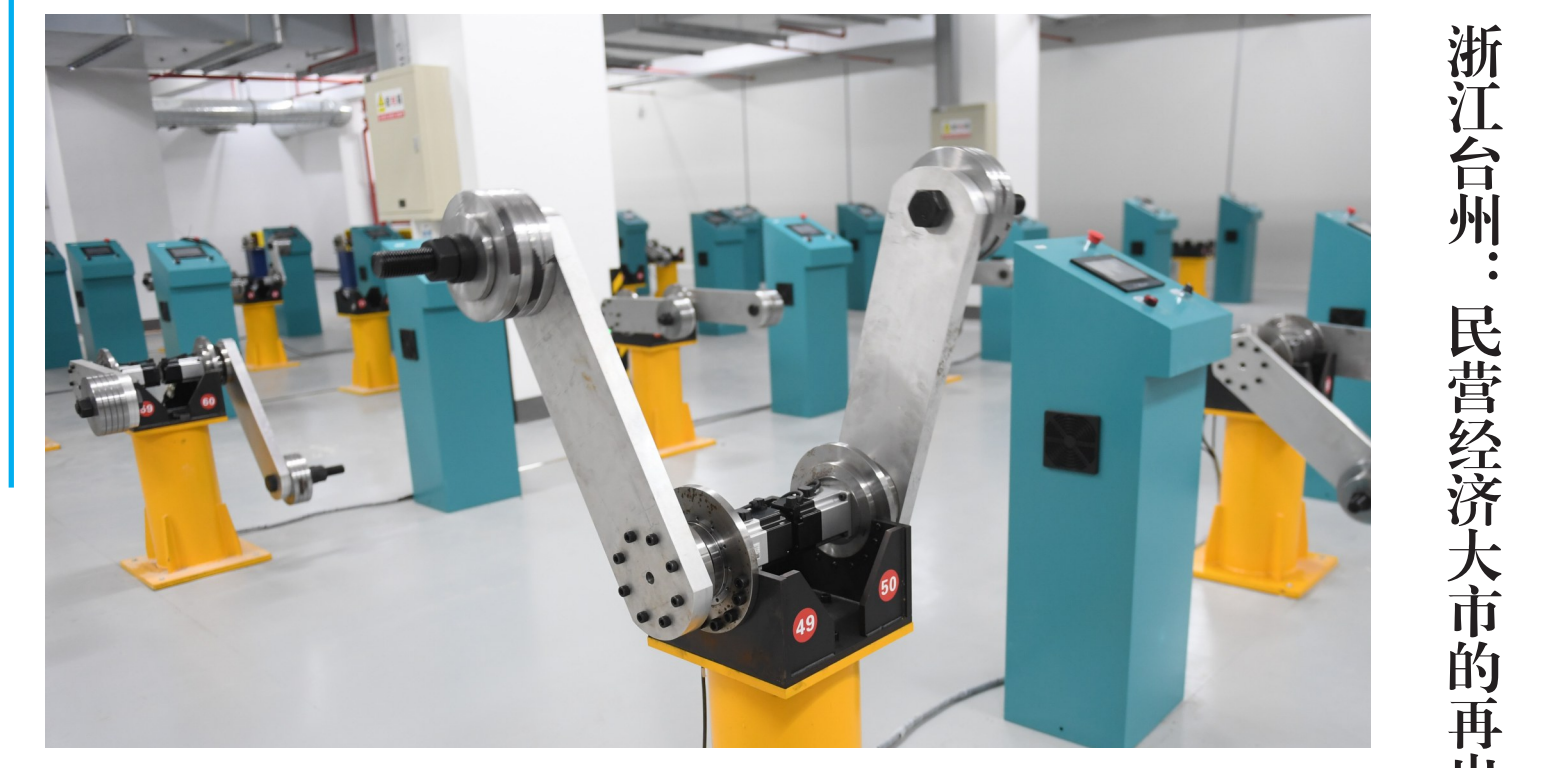
2月29日，在位于台州黄岩的国家级专精特新“小巨人”企业浙江丰立智能科技有限公司，自动化设备对应用于机器人关节的谐波减速器进行寿命测试。
